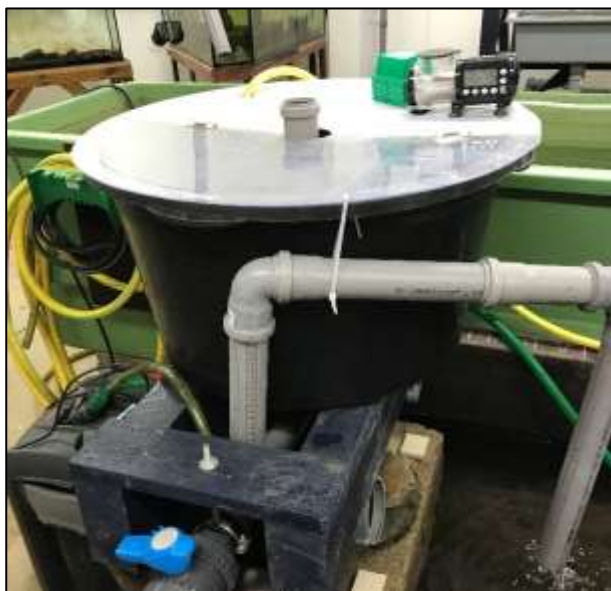
Billede 6 Tank med glochidieinficerede elritse. De små muslinger opsamles i sigten.
