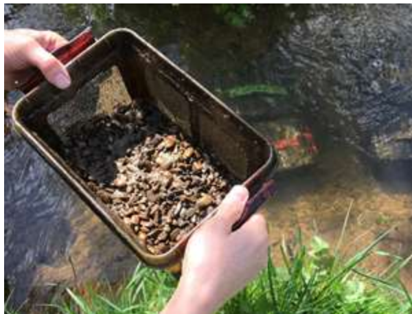
Billede 13 Kasser med småsten og muslinger. Kasserne skal jævnligt renses for silt og partikler.
