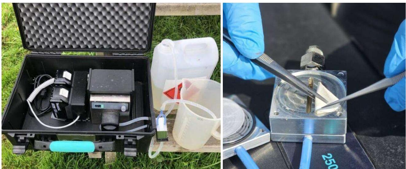
Figur 3.1: Tv.: filtrerings set-up, hvor den peristaltiske pumpe suger vand op fra beholder og presser det igennem filtersandwichen, hvor efter det opsamles i en målekande. Th.: en åben filtersandwich efter filtrering, filteret foldes før konservering i buffer.
